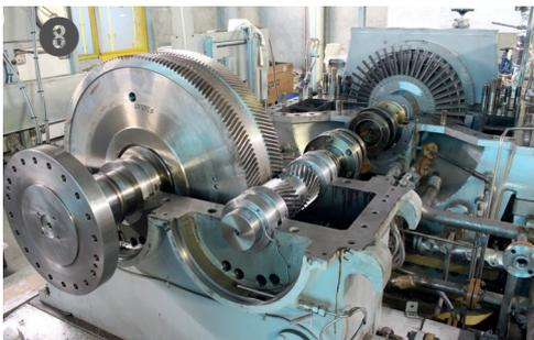
Le groupe turbo-alternateur\* a été entièrement démonté pour être révisé en Italie chez le constructeur (photo 7 et 8).
