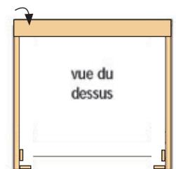
3 - Fixer enfin la planche fixe du couvercle sur l'arrière du composteur afin de renforcer la structure.
