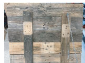
1 - Fixer les planches de structures du couvercle grâce aux planches de renfort : Chaque planche de renfort vient s'aligner à environ 16cm de chaque extrémité gauche et droite des planches de structure. Chaque planche de renfort vient également s'aligner sur la dernière planche du couvercle laissant ainsi environ 10cm de libre à l'avant.
